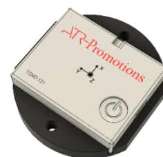
図4 位置センサと アタッチメントのイメージ
