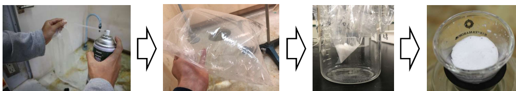
図2. 簡易アンモニアソーダ法による炭酸水素ナトリウムの合成実験
